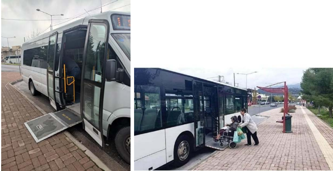
Εικόνα 2.1 Ανακλινόμενη ράμπα σε λεωφορεία του ΚΤΕΛ Αστικών Γραμμών Καλαμάτας
