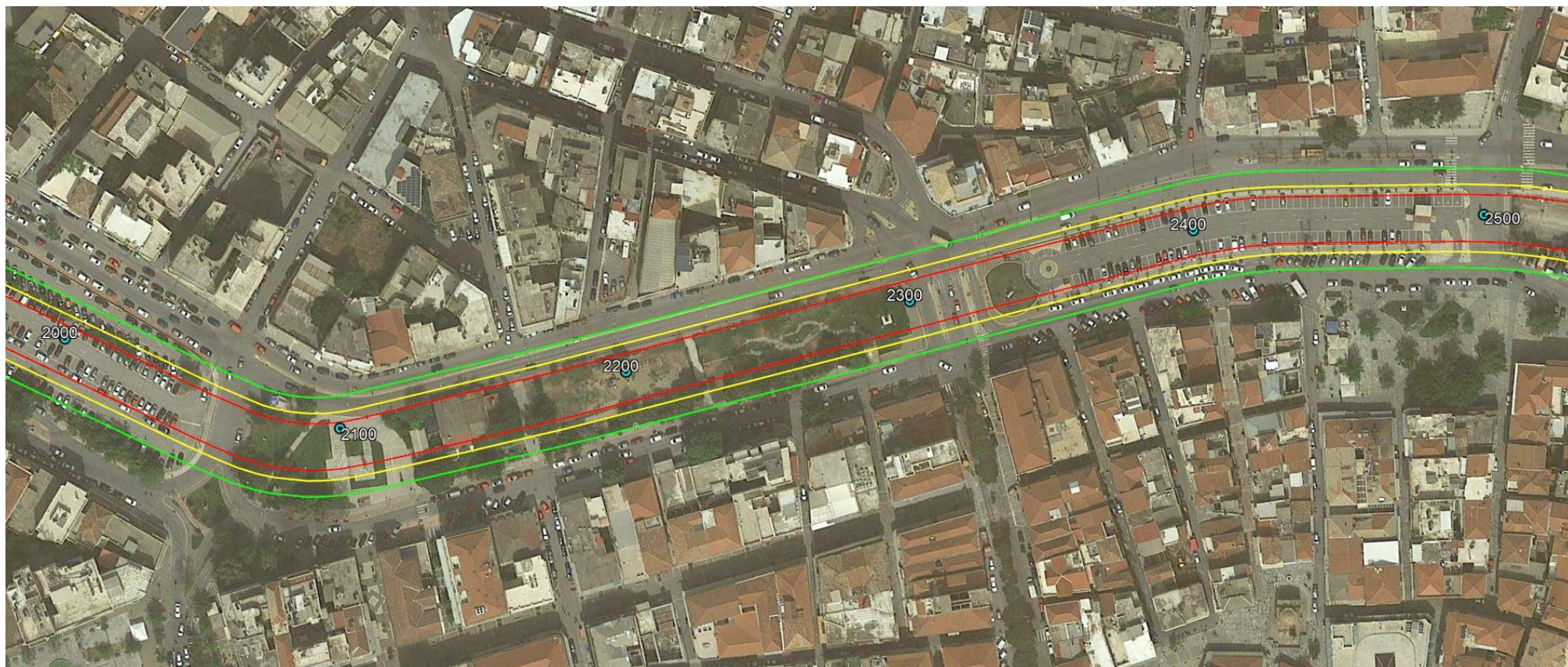
Εικόνα 6.16: Όριο έργου αναδιευθέτησης π. Νέδοντα από Χ.Θ. 2+000 έως Χ.Θ. 2+500 (κόκκινη γραμμή) και ζώνη εύρους 3,5m (κίτρινη γραμμή) και 9,0m (πράσινη γραμμή) πέριξ αυτού, όπου τα επίπεδα δονήσεων από τη λειτουργία ενδεικτικού περιστροφικού μηχανήματος κατασκευής πασσάλων και υδραυλικού σφυριού καθαίρεσης – αποξήλωσης αντίστοιχα, αναμένεται να είναι <math><3\text{mm/s}</math>.
