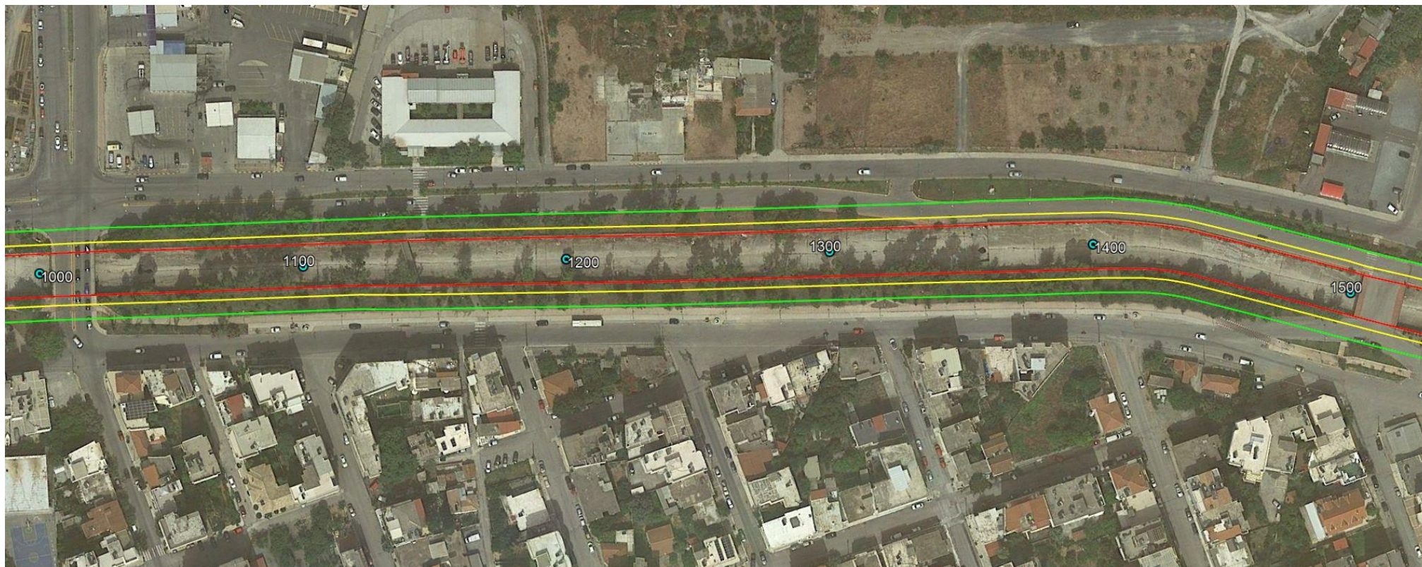
Εικόνα 6.14: Όριο έργου αναδιευθέτησης π. Νέδοντα από Χ.Θ. 1+000 έως Χ.Θ. 1+500 (κόκκινη γραμμή) και ζώνη εύρους 3,5m (κίτρινη γραμμή) και 9,0m (πράσινη γραμμή) πέριξ αυτού, όπου τα επίπεδα δονήσεων από τη λειτουργία ενδεικτικού περιστροφικού μηχανήματος κατασκευής πασσάλων και υδραυλικού σφυριού καθαίρεσης – αποξήλωσης αντίστοιχα, αναμένεται να είναι <math>< 3\text{mm/s}</math>.
