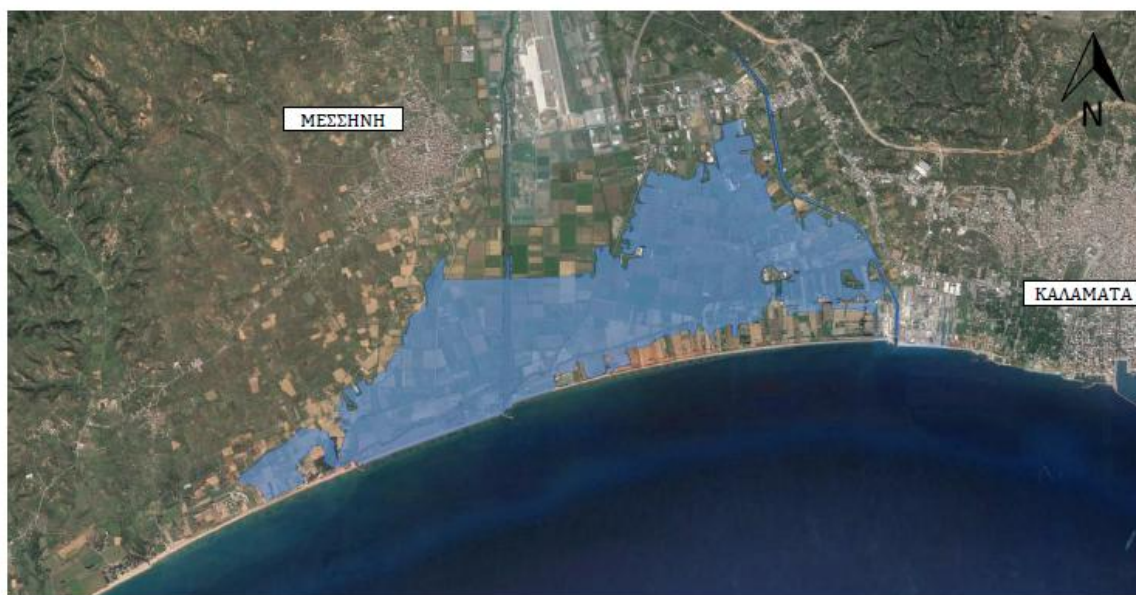
Εικόνα 8.17: Σχηματική απεικόνιση πλημμύρας από τη θάλασσα για την ΖΔΥΚΠ «Πεδινή περιοχή ρεμάτων Καλαμάτας - Μεσσήνης» - GR01RAK0001 (1.04m) (πηγή: Σχέδιο Διαχείρισης Κινδύνων Πλημμύρας ΛΑΠ ΥΔ Δυτικής Πελοποννήσου).
