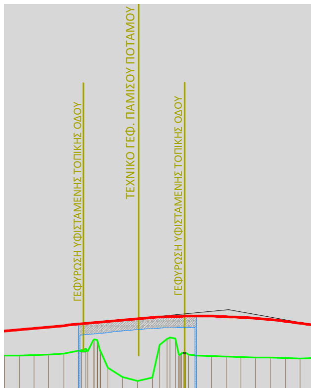
Εικόνα 9.2: Μηκοτομή τεχνικού γεφύρωσης έργου, με π. Πάμισο.
